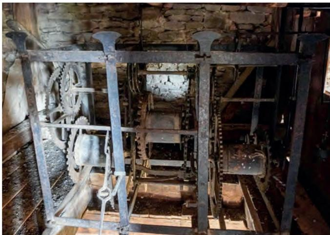
*Uhrwerk der Meschner Turmuhr
